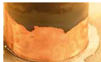
Come si presenta il fluxante alla temperatura ottimale per procedere con la brasatura
